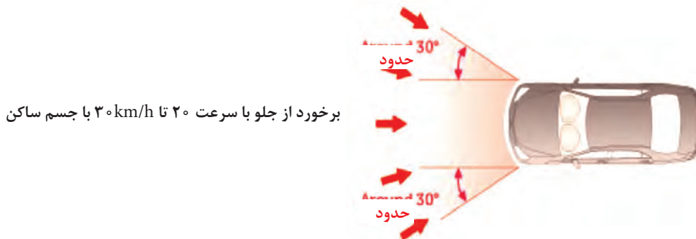
شکل ۵۴- شرایط فعال کردن کیسه هوای ایمنی (در برخورد از جلوی خودرو)
