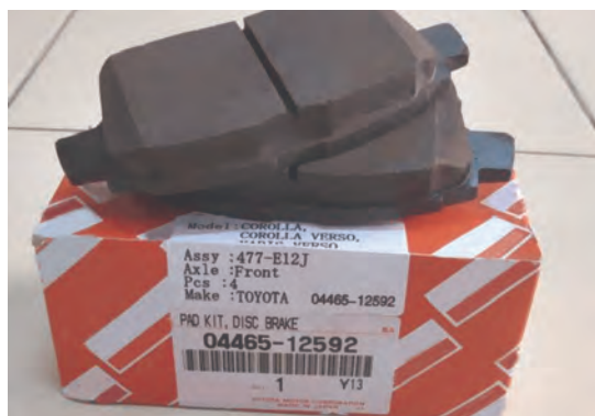
شکل ۶- نمونه‌ای از روش درج شماره فنی
