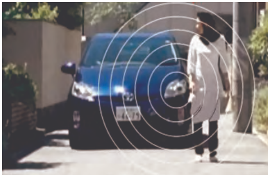
شکل ۴۵- سیستم صوتی نزدیک‌شونده خودرو
